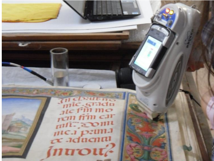
Fig. 1 – Lo spettrometro XRF Bruker Tracer durante le misure su un graduale miniato del Museo della Certosa.
